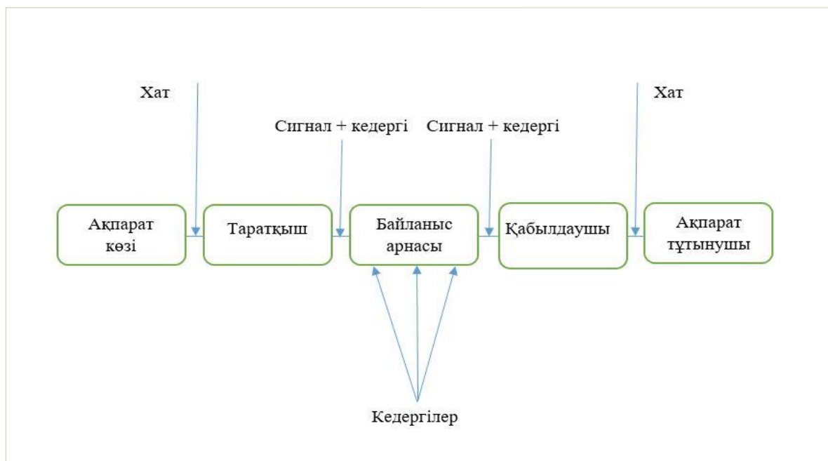
Сурет 1. Ақпаратты берудің автоматтандырылған жүйесінің схемасы
