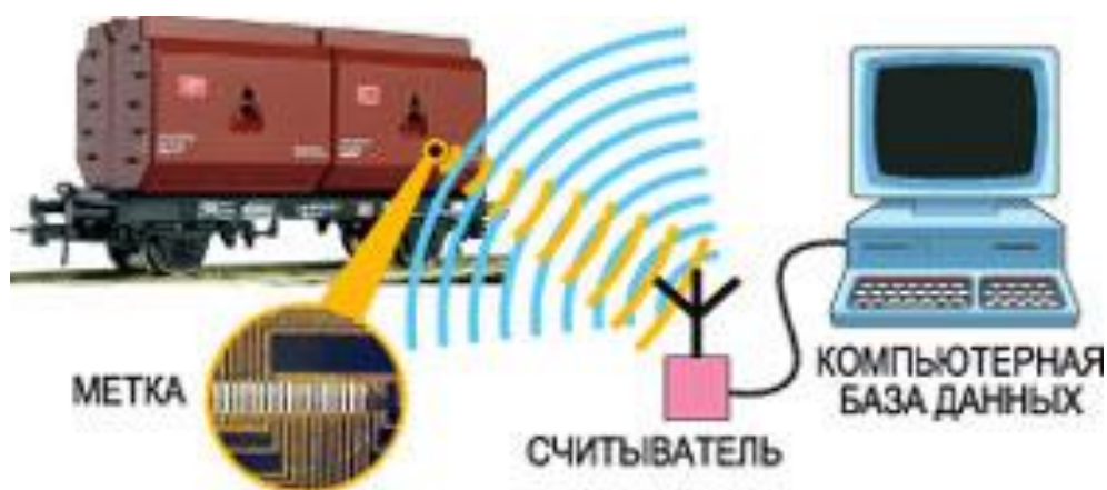
Рисунок 1 – Принцип работы RFID-технологии на ЖДТ
